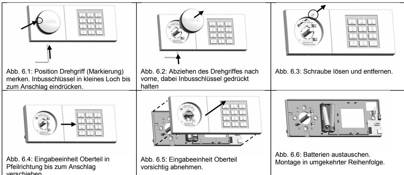
**Abbildung 6: Batterietausch**
